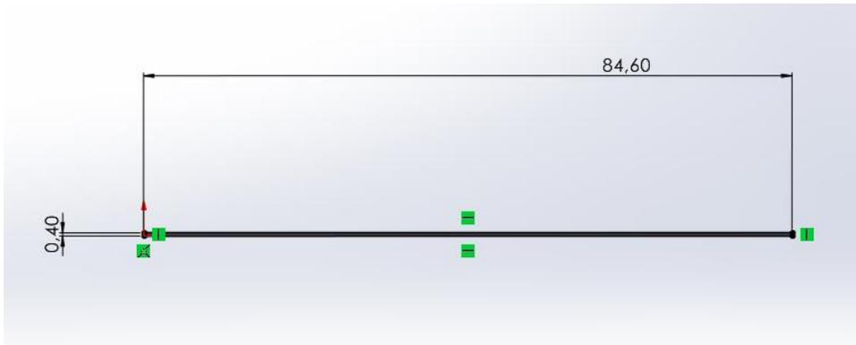
Figura 5.3: Sezione massima dello strato in titanal.
