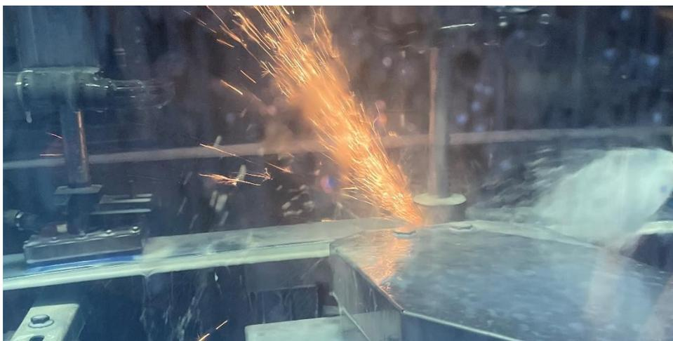
Figura 3.6: Operazione di finitura delle lamine dello sci.
